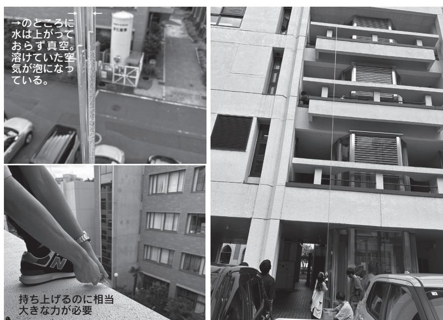
図5：パスカルの水柱の実験。ホース20m強に水を入れ、中央を4階まで引き上げると、上部には水のない真空ができる(→のところ)。
