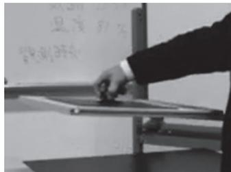
図3：「ゴムピタ君」のカタログ(上)とそれを使って板を持ち上げている様子(下)
